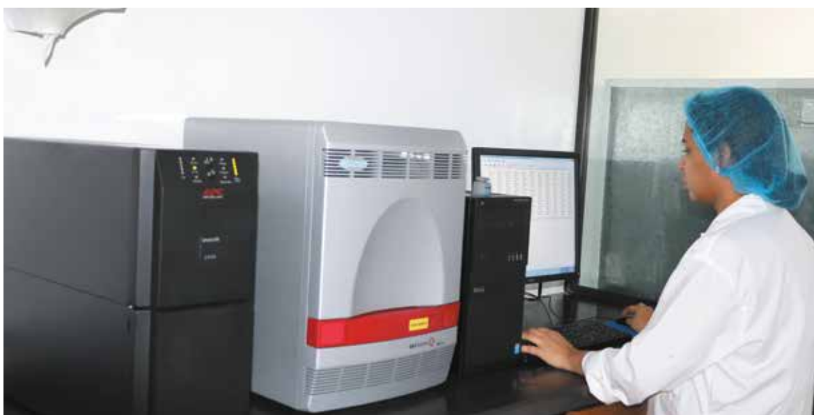
Equipo de diagnóstico mediante técnica de PCR en tiempo real, para la identificación de microorganismos patógenos en alimentos.
