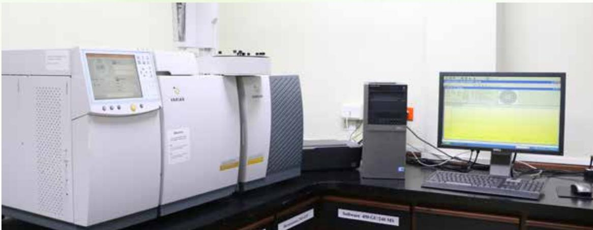
Equipo de Cromatografía de Gas y Espectrometría de Masas utilizado en determinación de residuos de plaguicidas.
