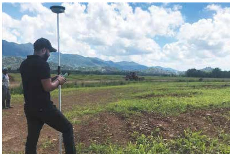
Técnico de Geotime realiza levantamiento de georeferenciación utilizando el Sistema RT.
