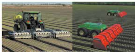
"Blue River BOT (Robot) de la Lechuga, puede revisar un Campo sembrado, tomar fotos de 5.000 Plantas por Minuto, Procesarlas, Identificarlas, y Eliminar la MALEZA"
