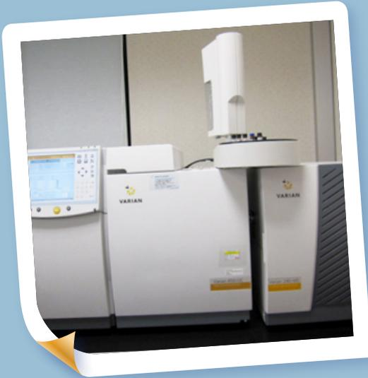
*Cromatógrafo de gas acoplado a espectrómetro de masas.*
